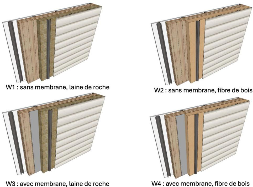
Figure 1. Composition des quatre murs testés
