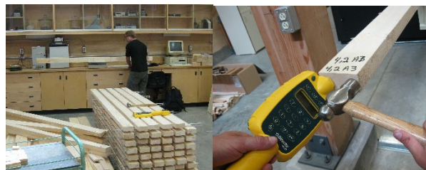
Figure 1. Pièces entreposées dans un laboratoire conditionné (20°C et 65 % RH). Mesure de la masse et de la vitesse sur une période de 35 jours.
