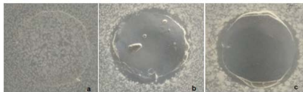
Figure 2. Test qualitatif selon la méthode AFNOR NF EN 1104 sur a) NFC, b) NFC/PPy, c) NFC/PVA-PPy
