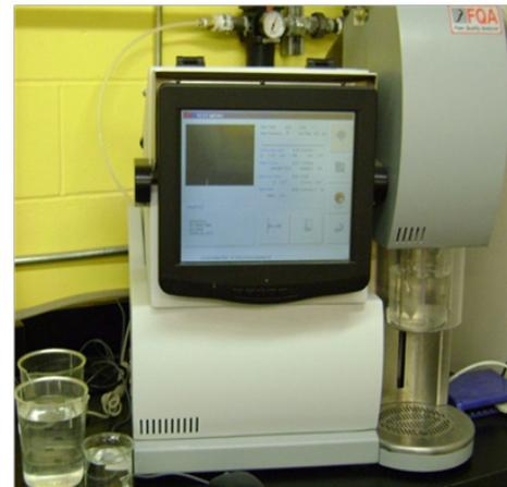
Figure 1. Analyseur de la qualité des fibres (FQA).
